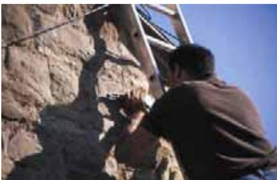
El siguiente paso es medir las lesiones. Medición del ancho de unas fisuras con un fisurómetro.
